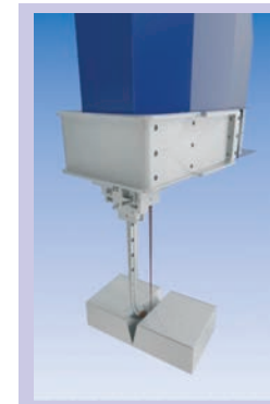
Abb. 2: Schweißkopf für das Laser-MES-Verfahren (CAD-Darstellung)
