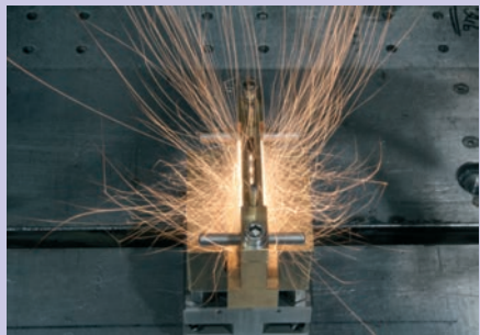
Abb. 4: Laserschweißprozess mit Scanner für Edelstahl
