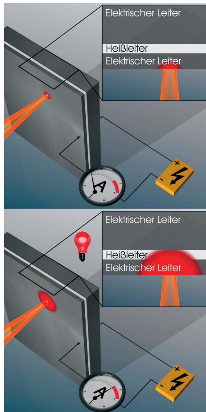
1 Schematische Darstellung des Funktionsprinzips der Laserschutzwand auf Heißeleiterbasis
